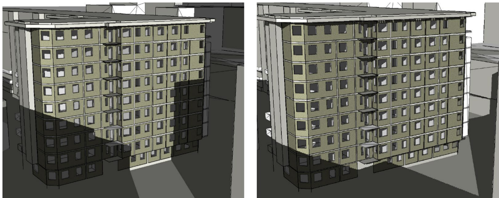
Skuggvisualisering östra fasaden Heden 39:15 klockan 9 respektive klockan 10. Efter klockan 10-11 ger planerad bebyggelse ingen påverkan på befintligt bostadshus (EQUA).
